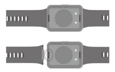
ストラップを取り外す:デバイス本体の両端のスーパーフィットボタンを押して、ストラップを デバイス本体から切り離します。
