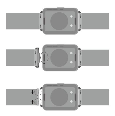
リンクを取り外す:デバイス本体の両端のスーパーフィットボタンを押して、リンクをデバイス本体から切り離します。
