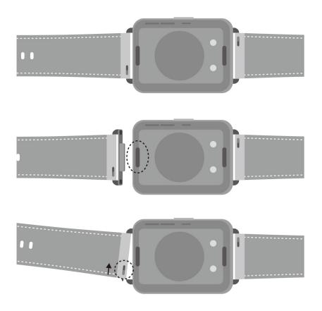
リンクを取り外す:デバイス本体の両端のスーパーフィットボタンを押して、リンクをデバイス 本体から切り離します。
