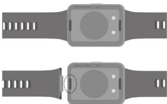
Armband entfernen: Drücke den Superfit-Knopf an beiden Enden des Uhrengehäuses, um das Armband vom Uhrengehäuse zu trennen.
