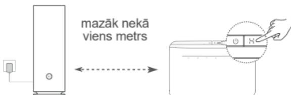
2. darbība: kad sāk mirgot ierīces HUAWEI CPE indikators, nospiediet tās pogu **H**. Uzgaidiet, līdz indikators uz maršrutētāja norāda, ka maršrutētājā ir izveidots savienojums ar tīklu.
