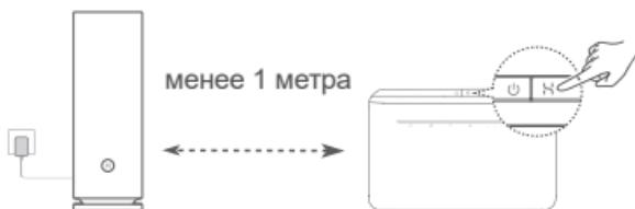
Шаг 2. Когда индикатор на устройстве HUAWEI CPE начнет мигать, нажмите на нем кнопку **H**. Дождитесь, когда индикатор на роутере укажет на то, что роутер подключен к сети.
