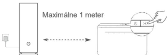
Krok 2: Keď indikátor na zariadení HUAWEI CPE začne blikáť, stlačte na ňom tlačidlo H. Počkajte, kým indikátor na smerovači nezobrazí, že je pripojený k sieti.
