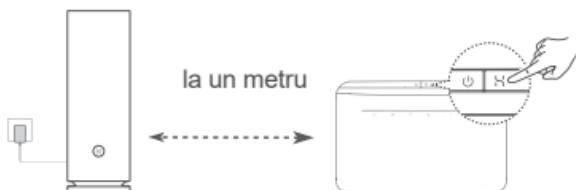
Pasul 2: Când indicatorul de pe HUAWEI CPE începe să lumineze intermitent, apăsați butonul **H** de pe sistem.
