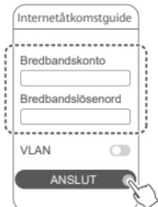
*i* Om du måste konfigurera VLAN på nätverket kontaktar du din bredbandsoperatör för att bekräfta VLAN-parametrarna och aktiverar VLAN-växeln på skärmen.
