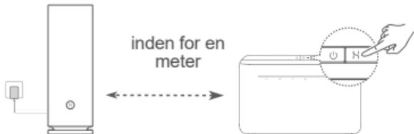
Trin 2: Når indikatoren på HUAWEI CPE begynder at blinke, skal du trykke på H-knappen på den. Vent, til indikatoren på routeren viser, at routeren er tilsluttet netværket.
