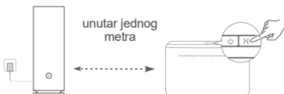
2. korak: kada pokazivač na uređaju HUAWEI CPE počne treperiti, pritisnite tipku H koja se nalazi na njemu. Pričekajte da pokazivač na usmjerivaču pokaže da je usmjerivač povezan s mrežom.
