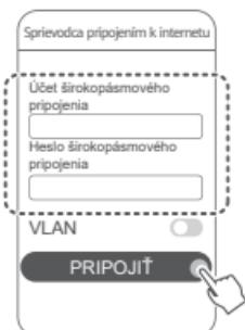
ⓘ Ak potrebujete nakonfigurovať siet' VLAN vo vašej sieti, kontaktujte svojho poskytovateľa širokopásmového pripojenia, aby ste potvrdili parametre siete VLAN a na obrazovke zapnite prepínač siete VLAN.
