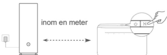
Steg 2: När indikatorn på HUAWEI CPE börjar blinka trycker du på **H**-knappen på enheten. Vänta tills indikatorn på routern visar att routern är ansluten till nätverket.
