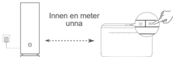
Trinn 2: Trykk på H-knappen når indikatoren på HUAWEI CPE begynner å blinke. Vent til indikatoren på ruteren viser at den er koblet til nettverket.
