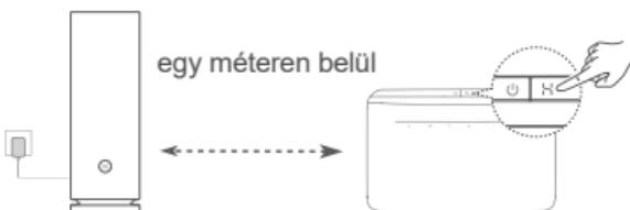
2. lépés: Amikor a HUAWEI CPE készüléken található jelzőfény villogni kezd, nyomja meg rajta a **H** gombot.
