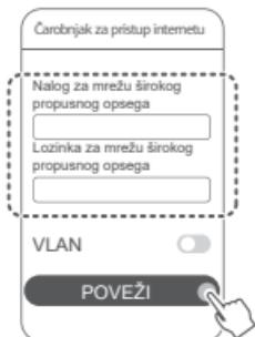
*i* Ako morate da konfigurišete VLAN na svojoj mreži, obratite se mrežnom operateru za mrežu širokog propusnog opsega da biste potvrdili VLAN parametre i omogućite prekidač za VLAN na ekranu.
