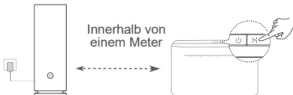
Schritt 2: Wenn die Kontrollleuchte am HUAWEI CPE zu blinken beginnt, drücken Sie dessen H-Taste. Warten Sie, bis die Kontrollleuchte am Router anzeigt, dass der Router mit einem Netzwerk verbunden ist.
