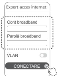
ⓘ Dacă trebuie să configurați VLAN în rețea dumneavoastră, contactați operatorul rețelei broadband pentru a obține parametrii VLAN și activați comutatorul VLAN de pe ecran.
