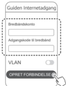
*i* Hvis du har brug for at konfigurere VLAN på dit netværk, skal du kontakte din bredbåndsdbyder for at bekræfte VLAN-parametrene og aktivere VLAN-kontakten på skærmen.
