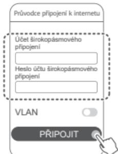
*i* Pokud potřebujete nakonfigurovat síť VLAN ve své síti, obrátěte se na svého poskytovatele širokopásmového připojení, ověřte parametry sítě VLAN a na obrazovce zapněte přepínač VLAN.
