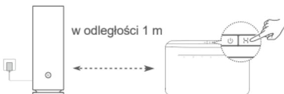
Krok 2: Gdy wskaźnik urządzenia HUAWEI CPE zacznie migać, naciśnij znajdujący się na nim przycisk **H**. Poczekaj, aż wskaźnik routera zasygnalizuje nawiązanie połączenia z siecią.
