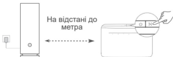
Крок 2. Коли індикатор HUAWEI CPE почне блимати, натисніть на ньому кнопку Н. Дочекайтесь сигналів індикатора, які свідчить про підключення маршрутизатора до мережі.
