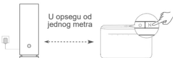
2. korak: kada indikator na HUAWEI CPE uređaju počne da treperi, pritisnite H taster na njemu. Sačekajte da indikator na ruteru pokaže da je ruter povezan na mrežu.
