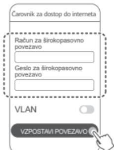
**i** Če morate v omrežju konfigurirati VLAN, se obrnite na svojega ponudnika širokopasovnih storitev, da preverite parametre za VLAN, in omogočite stikalo VLAN na zaslonu.
