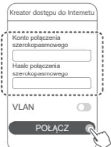
*i* Aby skonfigurować połączenie sieci VLAN w swojej sieci, skontaktuj się z operatorem sieci szerokopasmowej w celu potwierdzenia parametrów sieci VLAN, a następnie włącz przełącznik sieci VLAN na ekranie.
