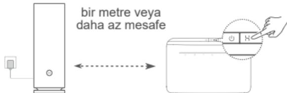
2. Adım: HUAWEI CPE cihazının göstergesi yanıp sönmeye başladığında üzerindeki H düğmesine basın. Yönlendiricinin göstergesi yönlendiricinin ağa bağlılığını gösterene kadar bekleyin.
