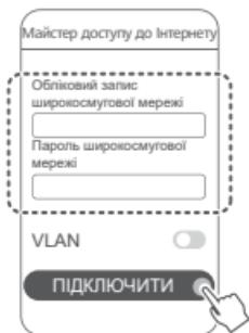
ⓘ Якщо вам потрібно налаштувати VLAN (віртуальну локальну мережу), підтвердьте її параметри в оператора широкосмугового доступу й увімкніть перемикач VLAN на екрані.
